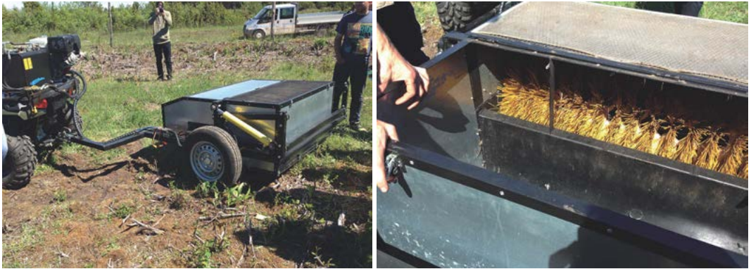
Abb. 4. Im Rahmen des estländischen Projekts LIFE to alvars (LIFE13 NAT/EE/000082) entwickelter und patentierter leistungsfähiger Samensammler für die Gewinnung des autochthonen Saatguts für Renaturierungsprojekte. – Fotos: J. Sliva, 2017.
