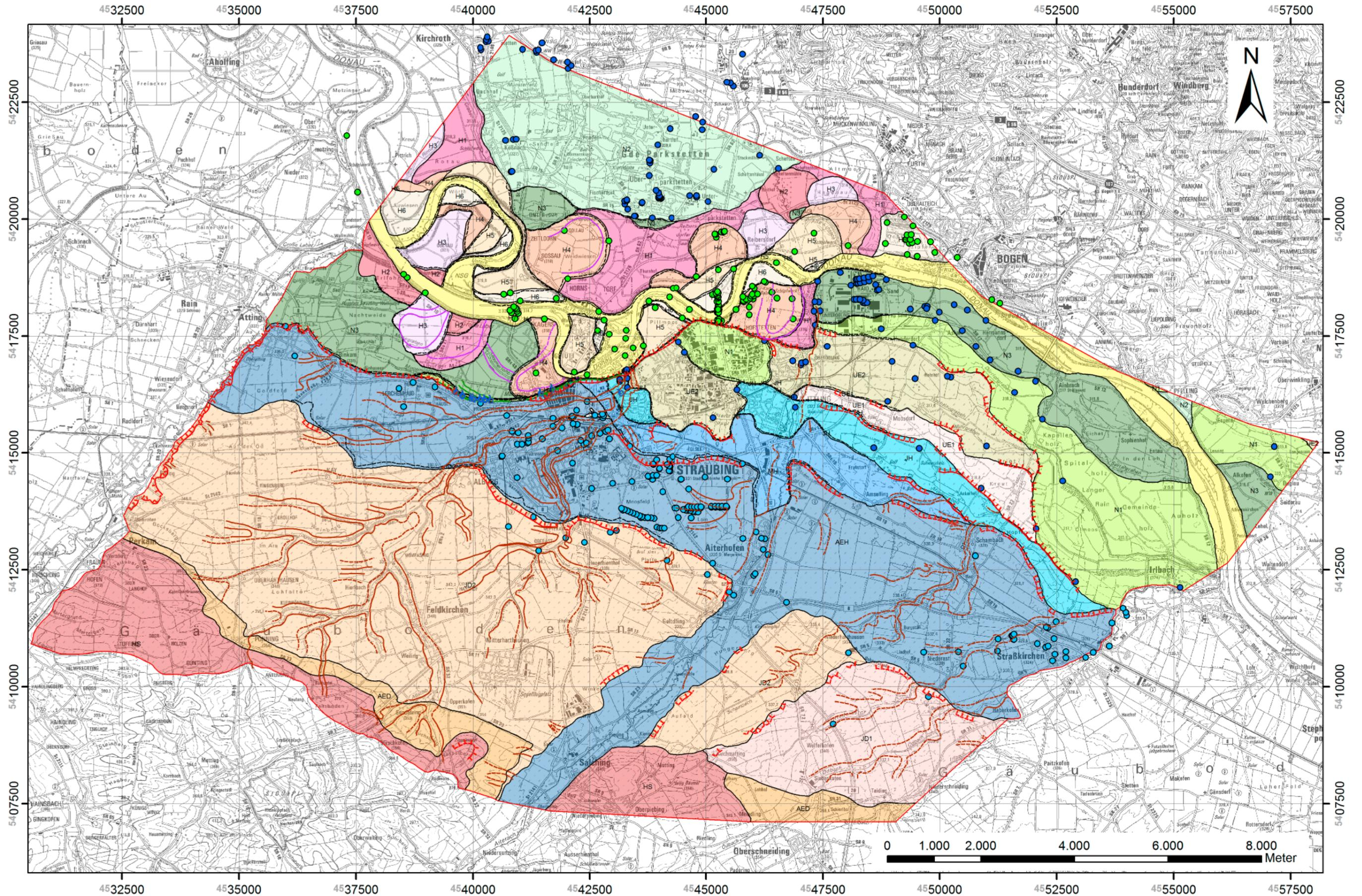
Abb. 9: Geologische Karte der quartären Einheiten in Straubing und Umgebung (nach SCHELLMANN 2010a, BRUNNACKER 1956). Das Profil A-A' wird in Abbildung 11 dargestellt. Die Karte kann großmaßstäblich auch unter [www.pfeil-verlag.de](http://www.pfeil-verlag.de) heruntergeladen werden.
