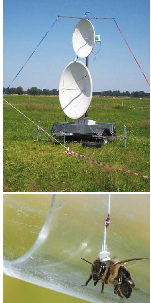
Abb. 1. Harmonisches Radargerät und Biene ( Apis mellifera ) mit Transponder. Die untere Radarschüssel sendet das Radarsignal aus, die obere empfängt das Signal, das von dem Transponder, den die Biene trägt, zurückgesendet wird. – Fotos: Randolph Menzel.
